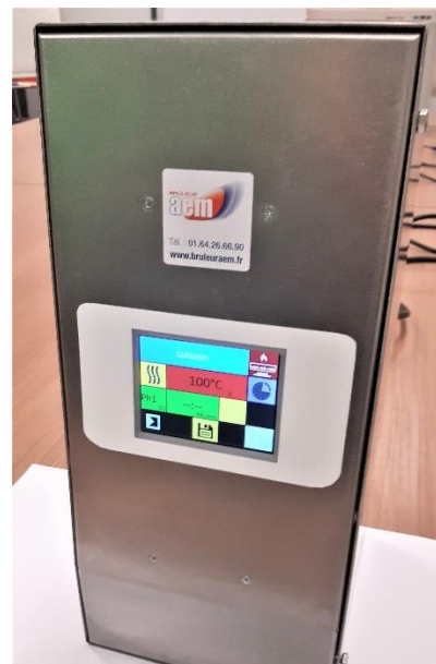
Pupitre de commande à 1 carte ET35ASBP pour le contrôle d'1 brûleurs à air soufflé et la régulation d'1 appareil de cuisson.
