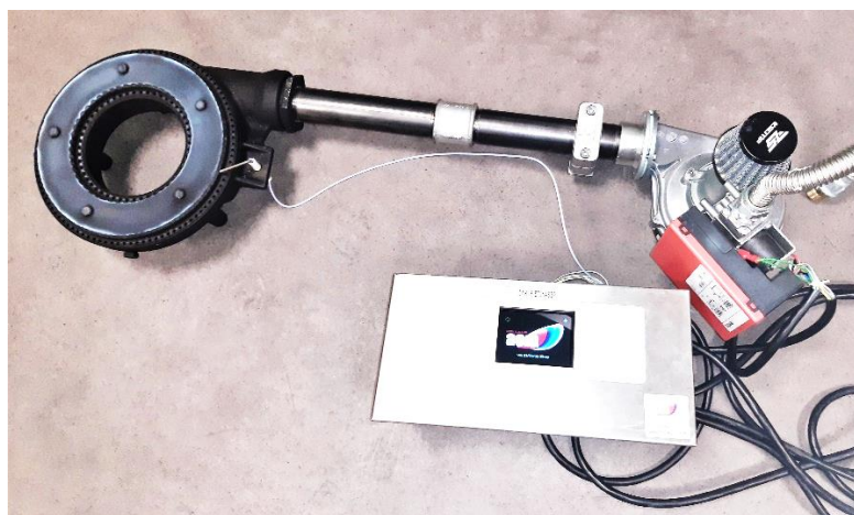
Brûleur circulaire FV240 à Air Soufflé de 35 kW.
