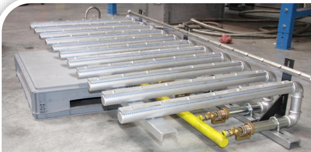
Ensemble de chauffe à 11 brûleurs rampe à PP en parallèle chauffage de plaque
